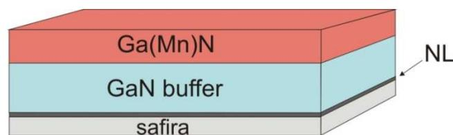
**Figura 4.5:** Esquema representativo da estrutura final de um filme de GaMnN.
