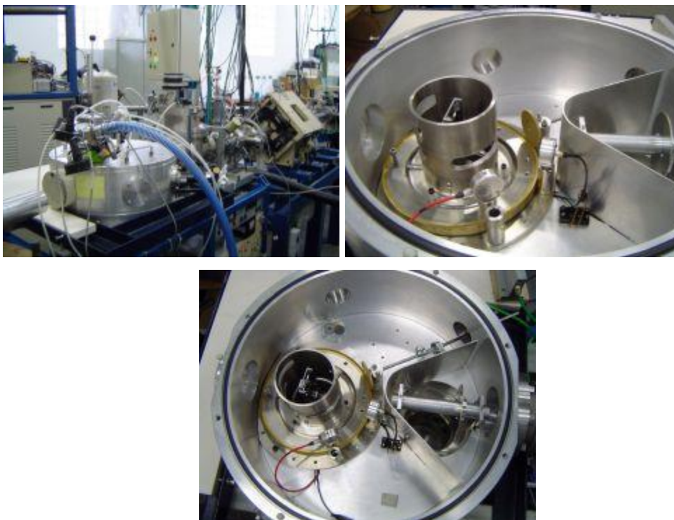
Figura 3.2 - Câmara porta amostras do RBS localizado no LAMFI-USP/SP. A câmara contém três detectores de barreira de superfície e um detector de raios-x tipo Si(Li). As amostras são montadas em um porta amostras móvel afixado num goniômetro com cinco graus de Liberdade, a troca de amostras pode ser realizada sem quebra de vácuo da câmara. A aquisição de dados é feita por um buffer-multicanal acoplado a um microcomputador pessoal.
